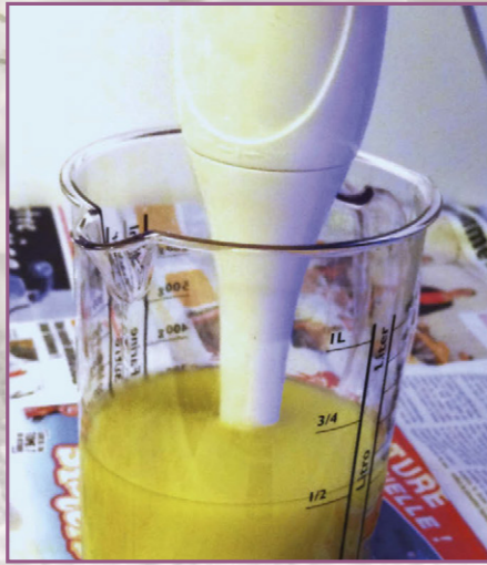
Étape 6 • À ce moment-là, versez la solution de soude dans les huiles. Il vous faut ensuite mélanger jusqu'à l'obtention de la « trace », épaisissement de la pâte. L'opération sera plus rapide si vous disposez d'un mixeur plongeant que vous pouvez réserver par la suite à cet usage.
